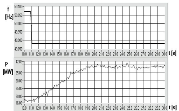
Fig. 8 - Caracteristica frecventa-putere in cazul unei perturbatii de -200 mHz
