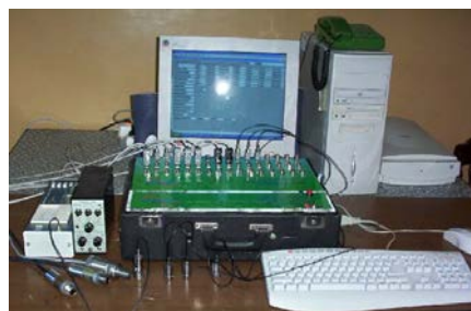
Fig.10 - Echipamentul pentru diagnosticarea echipamentului de comutatie
