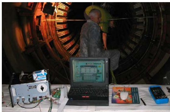
Fig.2 - Echipamentul PROFIM pentru proba fierului cu inductie mica
