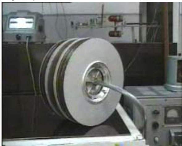
Рис. 1. Резистор с подавлением высокочастотных компонент для защиты устройств электротехнического оборудования.
