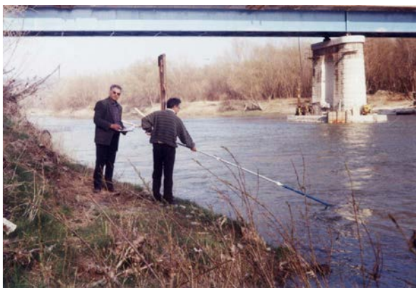
Fig.15. Măsurarea vitezei apei cu aparatul Flow Probe FP în r.Prut, Lipcani, în secțiunea podului nou
