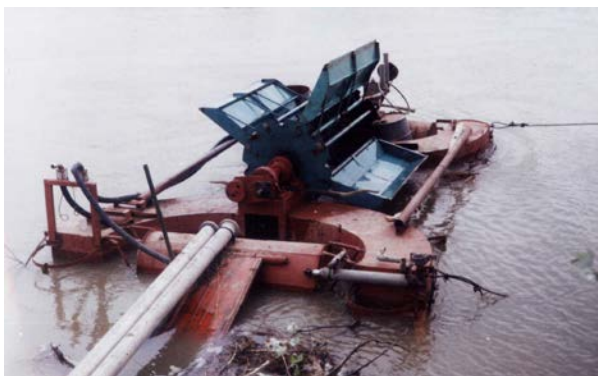
Fig.16. Instalație plutitoare hidroenergetică pe r.Prut (Stoianești, r.Cantemir) pentru pomparea apei în iaz.
