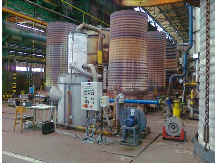
Рис. 5 Рекуператор конструкции Института газа НАН Украины на колпаковой печи компании DUNAFERR RT (Венгрия)
