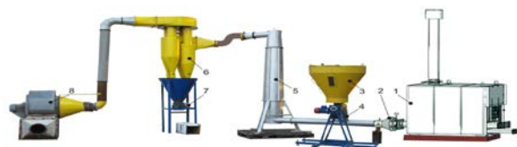
Рис.9. Экспериментальный технологический участок сушики измельченного растительного сырья с использованием макета вихревой сушилки
