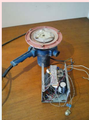
Invertor cu trei faze pentru alimentarea motoarelor cu frecvență de 200 Hz ( cu convertizor de tip forward)
