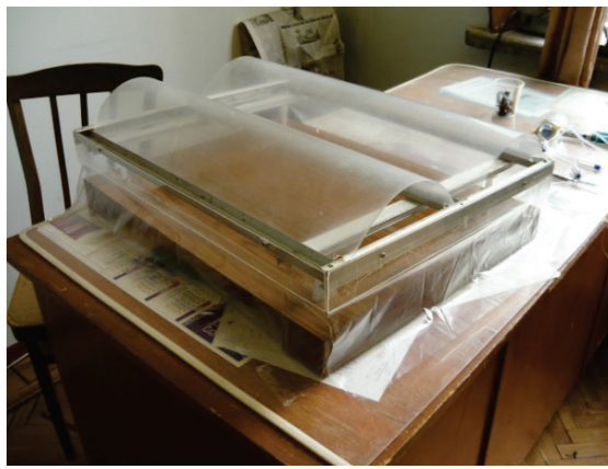
Fig.3. Seră solară cu reglare multilaterală (unghi de înclinare, direcție și înălțime față de sol)
