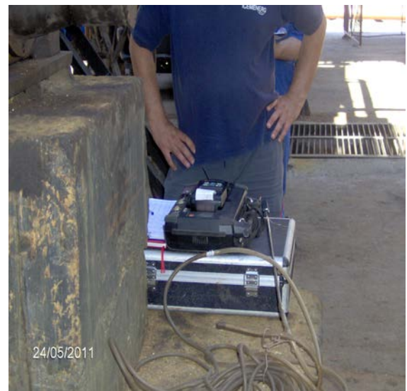
Fig.7 Efectuarea de teste si analize: analiza gaze de ardere
