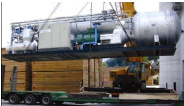
Figura 2. Instalație ORC, 400 kW, Austria [5]
