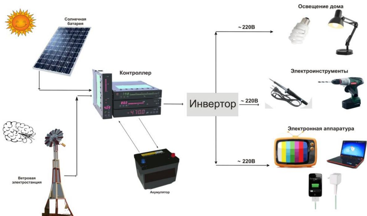
Рис.1. Типовая функциональная схема обеспечению электроэнергией
