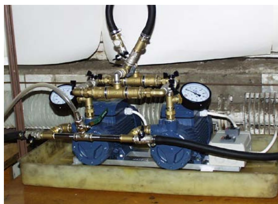
Рис.6б. Установка для получения смешанного водомазутного топлива производительностью 2 тонны в час
