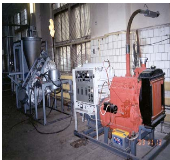
Рис. 7. Образец мини-ТЭС электрической мощностью в диапазоне 30-100 кВт с модулем пиролиза производительностью 1 тонна растительного сырья в сутки
