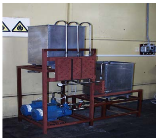
Рис.6а. Установка для получения смешанного биодизельного топлива производительностью 2 тонны в час
